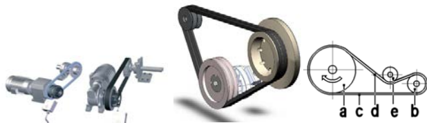
Рис. 5. Найпоширеніша конструкція пасової передачі
